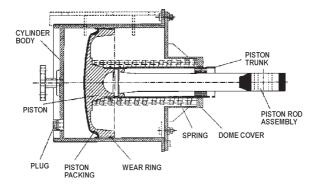
Fig. 3.42 Brake Cylinder
