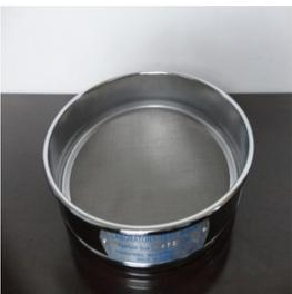
**Fig. 4: 425 micron IS Sieve**
