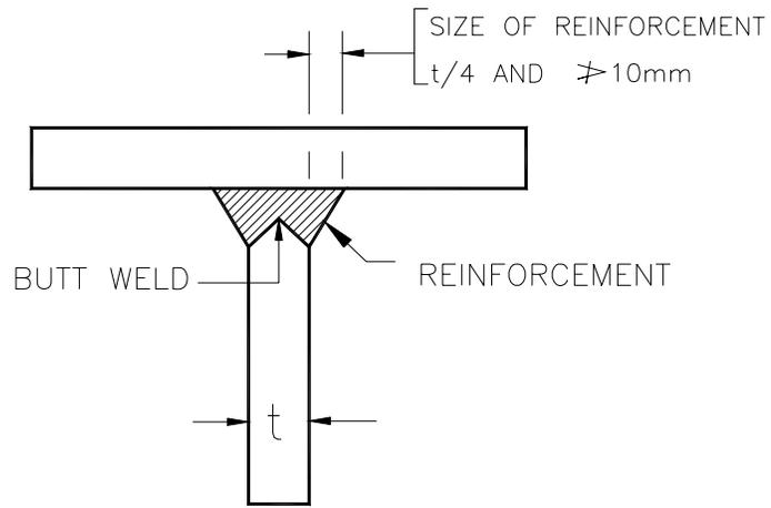
BUTT WELDED T JOINT
