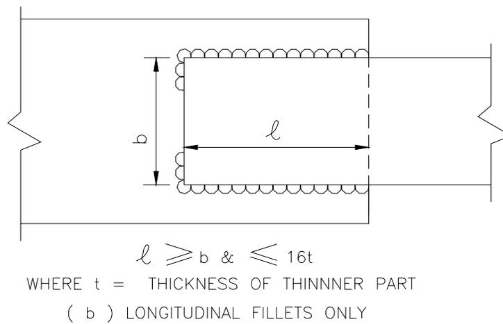
**FILLET WELDS IN LAP JOINTS**
